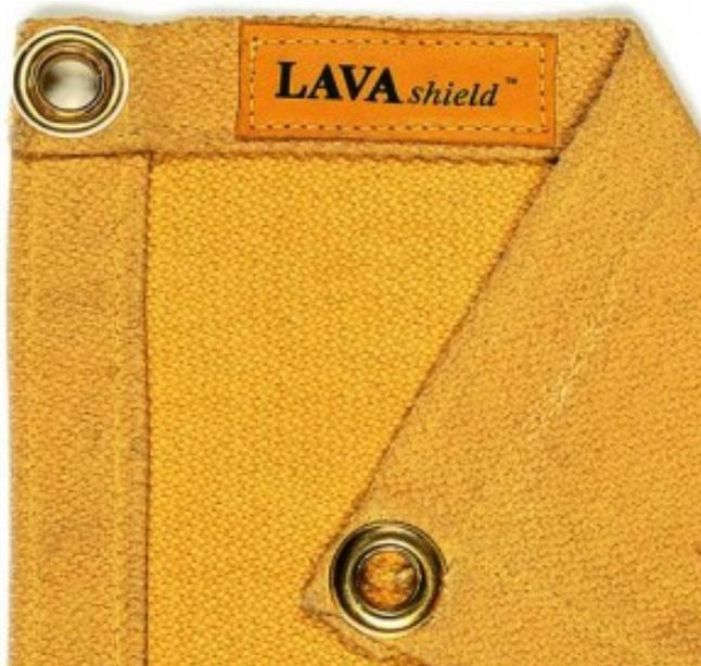
Diese Schweißerschutzdecke: - besteht aus Glasfaser mit einem Flächengewicht von ± 1.000 gr./m<sup>2</sup>, - hat ein Golden / Gelbe Farbe, - hat an eine Seite ein Schicht von Acryl und eine Seite ein Schicht von Neoprene, - ist temperaturbeständig bis ± 550°C, - hat eine Größe von 174 x 234 cm, - ist seitlich gesäumt und mit 10 Ösen versehen, - wird mit 3-fachem Kevlar®-Garn vernäht.
