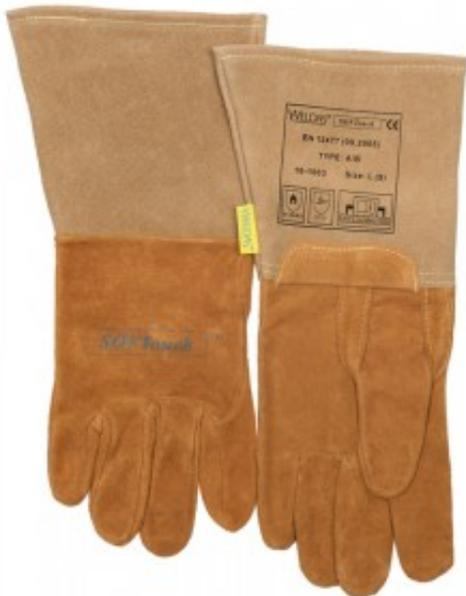
Weldas® WIG Handschuhe (10-1003, 10-1005, 10-1009, 10-1050), haben einen 'nahtlosen' Zeigefinger. Dies gibt ungehinderte Kontrolle über Schweißelektroden mit einem kleinen Durchmesser und ultra-leichtem WIG-Brenner. Diese Ausführung verhindert das Ausbrennen der Nähte sowie Abrieb.
